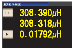
变压器测量模式 漏感测量界面
