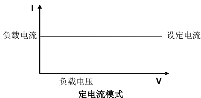
图 3-1 CC 模式电压电流关系图
