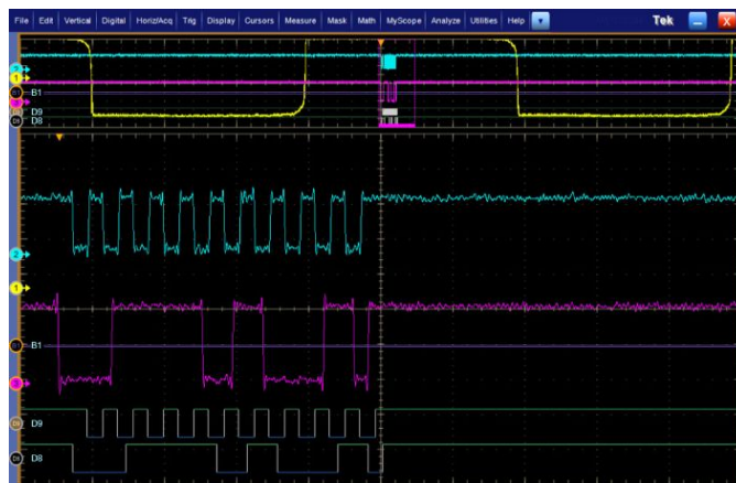
集成的逻辑通道 - 为系统调试提供时间相关的模拟与数字可视性。
