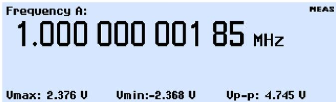
三条输入通道让您测量不同信号之间的关系。例如，您可以测量设备输入信号与输出信号之间的相位关系。利用多参数显示，您可以同时读取其他关键的参数，比如信号与电压比的测试频率（以 dB 为单位），一切都一目了然。
