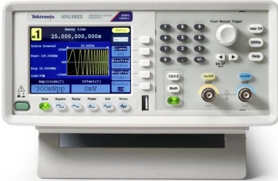
AFG1000 系列任意波形发生器提供了性价比最好的波形生成工具。它包括两个双通道型号，最高 60MHz 带宽，最高 10 V<sub>p-p</sub> 输出幅度。4 种运行模式、50 种内置常用波形和内置 200 MHz 频率计数器，满足试验和测试工作中的大多数波形发生需求。3.95 英寸 TFT LCD、快捷按钮、USB 接口和 PC 软件提供了最直观的仪器配置方式。
