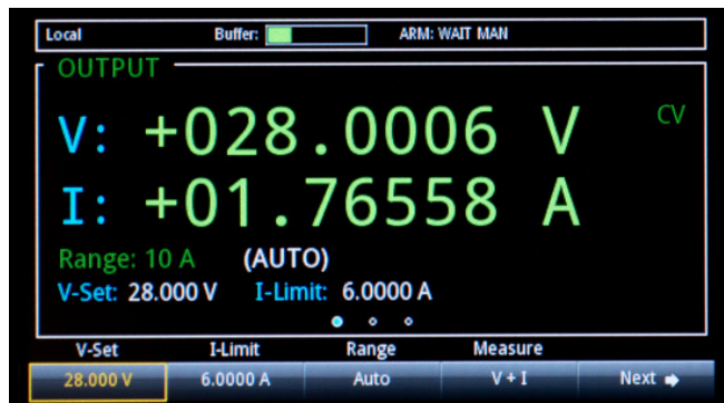
图3 通过主屏调整电压、电流、电流量程、测量模式、保护等级和其他功能。
