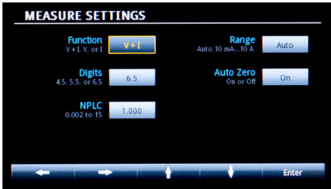
图5 通过测量子屏幕，根据用户需要对回读测量进行配置
