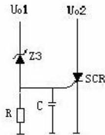
如上图，当  $U_{o1}$  输出升高，稳压管（Z3）击穿导通，可控硅（SCR1）的控制端得到触发电压，因此可控硅导通。 $U_{o2}$  电压对地短路，过流保护电路或短路保护电路就会工作，停止整个电源电路的工作。当输出过压现象排除，可控硅的控制端触发电压通过 R 对地泄放，可控硅恢复断开状态。
