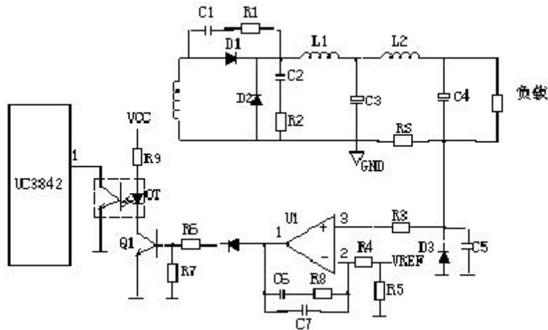
上图是常见的输出端限流保护电路，其工作原理简述如上图：当输出电流过大时，RS（锰铜丝）两端电压上升，U1③脚电压高于②脚基准电压，U1①脚输出高电压，Q1 导通，光耦发生光电效应，UC3842①脚电压降低，输出电压降低，从而达到输出过载限流的目的。
