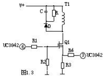
当输出电路短路或过流，变压器原边电流增大，R3 两端电压降增大，③脚电压升高，UC3842⑥脚输出占空比逐渐增大，③脚电压超过 1V 时，UC3842 关闭无输出。
