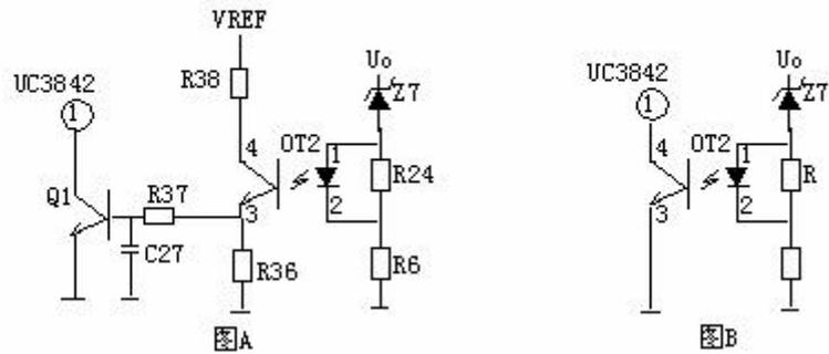
如上图，当  $U_o$  有过压现象时，稳压管击穿导通，经光耦（OT2）R6 到地产生电流流过，光电耦合器的发光二极管发光，从而使光电耦合器的光敏三极管导通。Q1 基极得电导通，3842 的③脚电压降低，使 IC 关闭，停止整个电源的工作， $U_o$  为零，周而复始。
