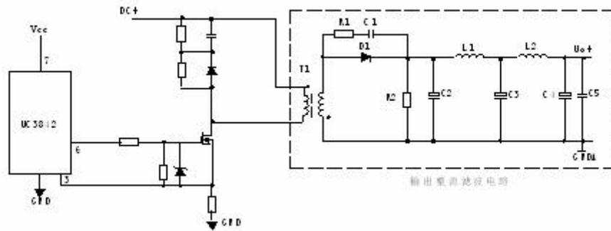
T1 为开关变压器，其初极和次极的相位相反。D1 为整流二极管，R1、C1 为削尖峰电路。L1 为续流电感，R2 为假负载，C4、L2、C5 组成  $\pi$  型滤波器。
