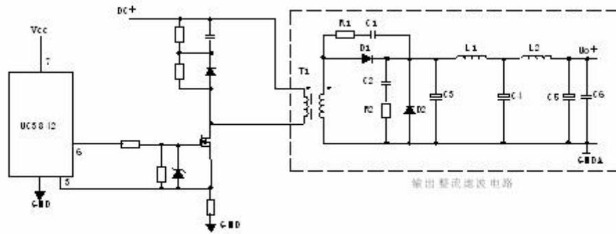
T1 为开关变压器，其初极和次极的相位同相。D1 为整流二极管，D2 为续流二极管，R1、C1、R2、C2 为削尖峰电路。L1 为续流电感，C4、L2、C5 组成  $\pi$  型滤波器。
