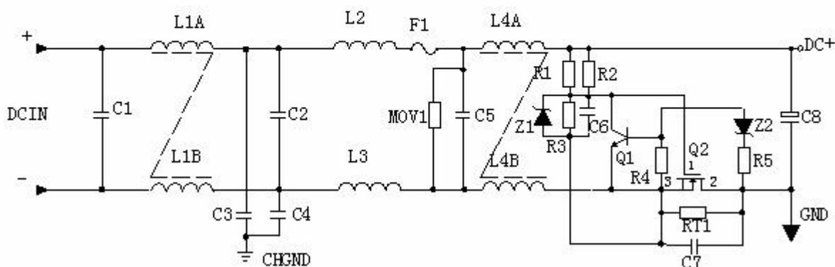
① 输入滤波电路：C1、L1、C2 组成的双  $\pi$  型滤波网络主要是对输入电源的电磁噪声及杂波信号进行抑制，防止对电源干扰，同时也防止电源本身产生的高频杂波对电网干扰。C3、C4 为安规电容，L2、L3 为差模电感。
