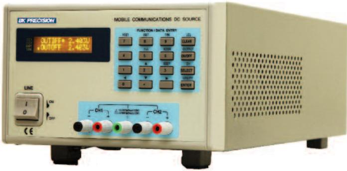
PPS1201GSM-A-MO 是一台可測試手持式產品內部充電電路及供電功能的直流電源供應器，兩組輸出都同時具有 Power 及 Sink 功能。當為 Power 的角色時，可量測 3mA 檔位的待機電流(解析度高達 1uA)，當為 Sink 的角色時，可模擬為電池負載，並且量測手持式產品的充電電壓及電流。針對手持式產品而設計出來的 PPS1201GSM-A-MO，不僅可以減少測試的步驟與使用的儀器數量，壓降補償功能(Remote Sense)更可讓輸出電壓準確無損的送至待測物，再透過標準的 GPIB 介面實行自動化測試，讓此台 PPS1201GSM-A-MO 達到客戶對它的期望。
