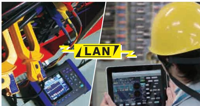
若使用无线路由器，也可通过平板电脑在远离现场的地方进行远程操作。
