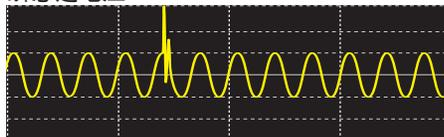
可测量最大6,000V、最小1μs(2MS/s)幅度的瞬态过电压。
