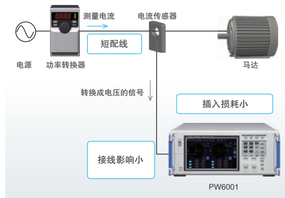
电流传感器方式的测量示意图
