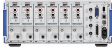
PW6001-16(6ch, 带马达分析&D/A输出)
