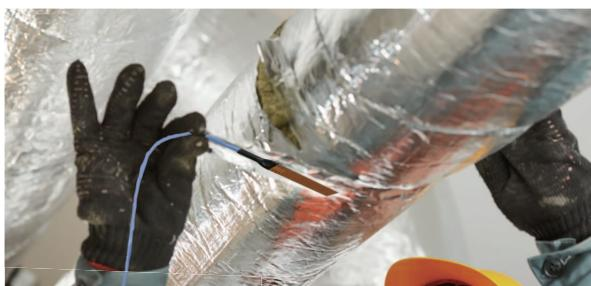
因为可以自由弯曲，对于现在一般比较难以测量的管材等弧形地带可轻松测量
