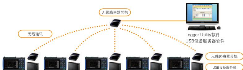
※按照通讯状态可能出现无法进行10ms通讯的情况。※无线LAN通讯在日本以外无法使用。
