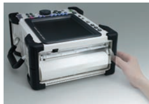
打开装入记录纸后关闭即完成设置的简单设计
