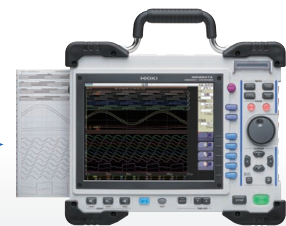
数字电压计单元 最多可扩展至8个模块, 16ch
