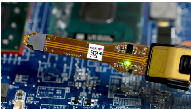
P77STFLXA 焊接柔性电路附件在尖端上有一个有源缓冲放大器，提供了高达 20 GHz 的带宽。
