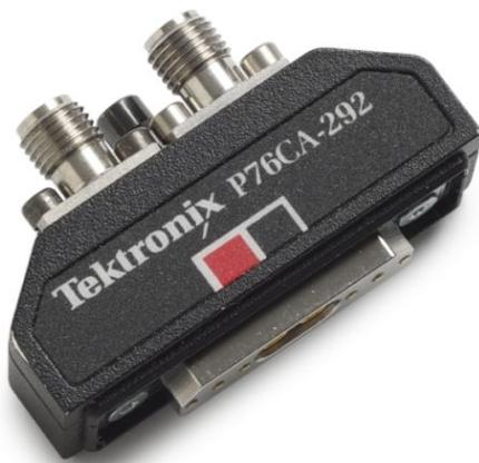
33 GHz 带宽同轴适配器，带 2.92 mm (孔型) 连接器。此适配器在输入连接器上校准，非常适用于与现成的或定制的电缆配合使用。应使用低时滞电缆对以保持全带宽性能。
