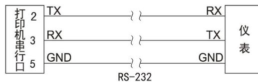
本仪表具有与上位机通讯功能，上位机可完成对下位机的自动调校、参数设定、数据采集、监视控制等功能。配合工控软件，在中文 WINDOWS 下，可完成动态画面显示、仪表数据设定、图表生成、存盘记录、报表打印等功能。技术指标通讯方式串行通讯 RS485，RS232 等波特率 1200~9600 bps 数据格式 一位起始位，八位数据位，一位停止位
