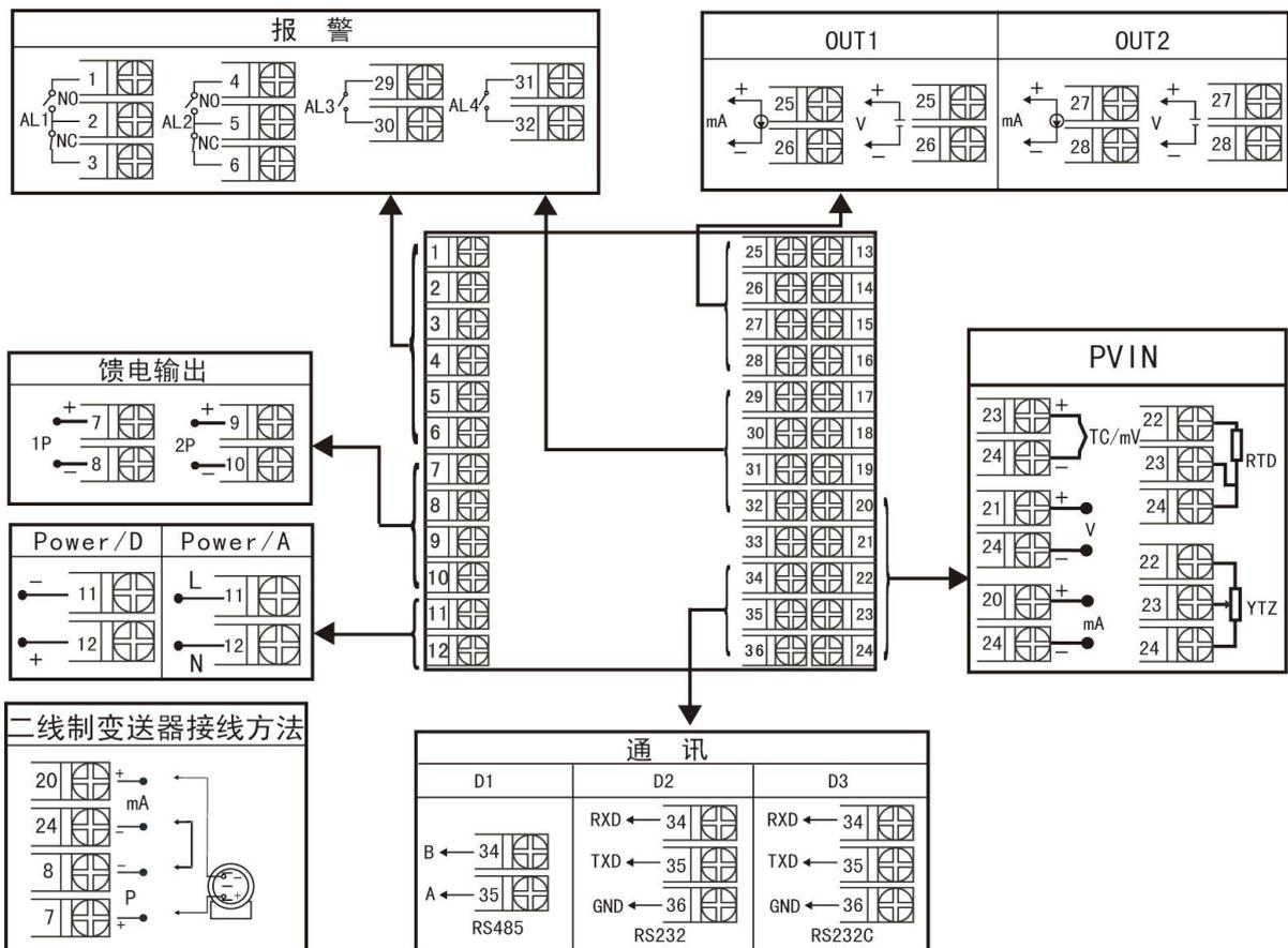
规格尺寸为 A、B、C、D、E、K、L、M 型接线图
