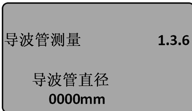
注：导波管设定必须导波管存在的情况下才可设定有效。
