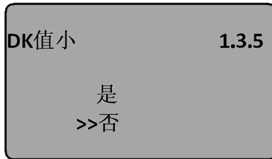
按→键选择“是，”用于 DK 值小时的测量设定，液晶显示如下，这时需要人工输入一个准确的空罐空高值，该值用于判断罐底的位置，以减少罐底的反射
