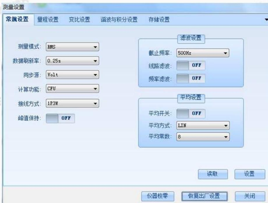
图 7.6 PF330 测量设置界面
