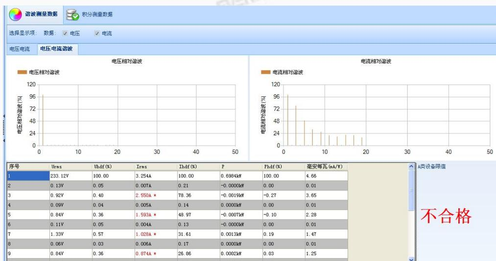
图 7.10 谐波测量显示窗口（单次谐波）
