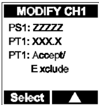
位表示、输入最大测量范围值，通常该浓度值时电流输出为20 mA。此情况下，变送器将会根据PT 1值数据外推出一条校准标准曲线。请注意，输入的最大测量范围值应不小于或者等于PT 1值。
