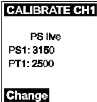
6、在“**Change**”（更改）选项下再次按**左键**，当前**PT 1**值会变亮。将**PT 1**值改变为以所选工程单位表示的、您所估计的当前工艺中此处悬浮固体浓度值。使用**右键**改变数字位数，按**回车键**确认更改结果并将光标移至下一个待修改处。完成上述操作后按**回车键**确认，屏幕上会显示“**current cal**”（电流校准）。
