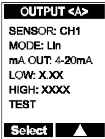
∅ “**Lin**”（简单线性输出）模式对应于测量结果将输出0~20 mA或者4~20 mA的信号。输入“**LOW**”和“**HIGH**”（最小值和最大值），应用您在工艺中使用的工程单位（该工程单位在“**CALIBRATION**”（校准）菜单显示屏幕上选定）。该模式包含了需要跟踪电流输出的整个工艺测量范围。
