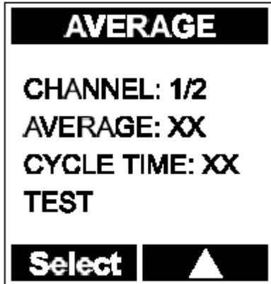
“**CHANNEL**”（通道）：选择将要设置参数的通道。使用**右键**在两个通道之间进行选择。
