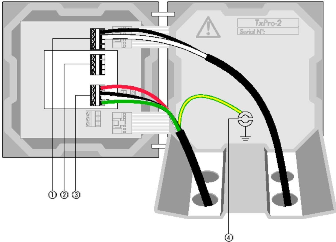
图11 电流输出和传感器的连接
