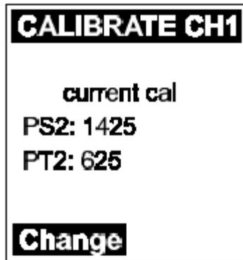
13、按一次**退出键**，进入下一个稍低浓度的校准点，对其重复步骤6、步骤7和步骤8的操作。
