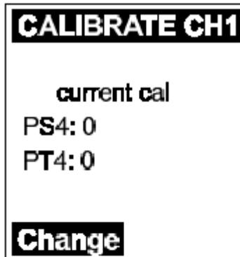
6、在“Change”（更改）选项下按**左键**，“current cal”（电流校准）状态会变为“PS live”（探头信号工作），屏幕上会显示实时探头信号。
