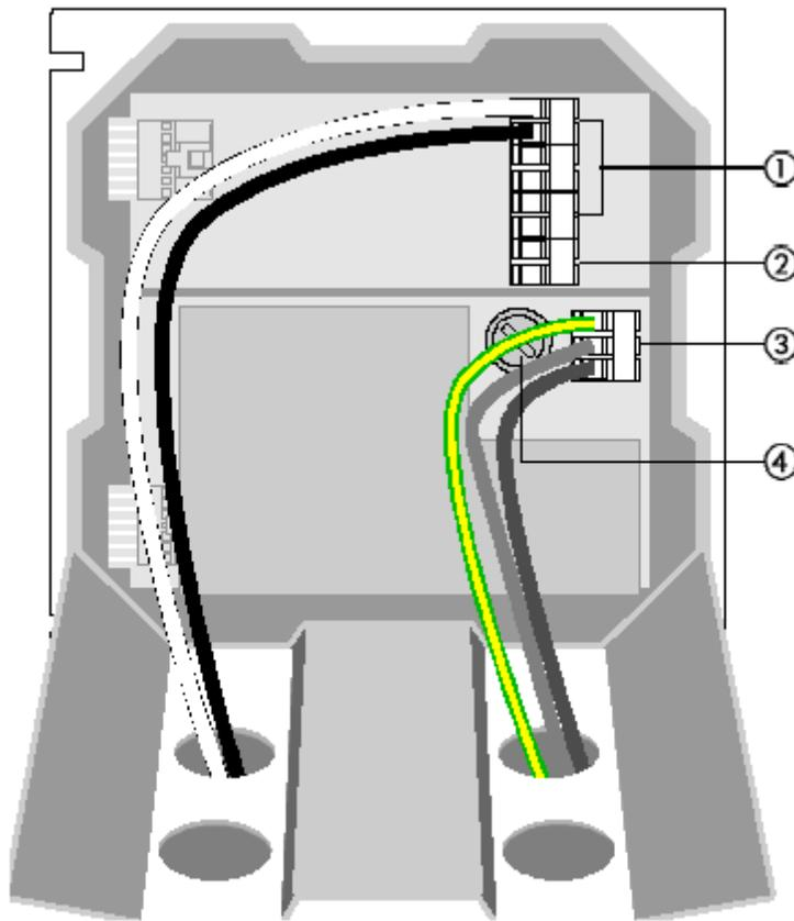
图10 电源和继电器的连接
