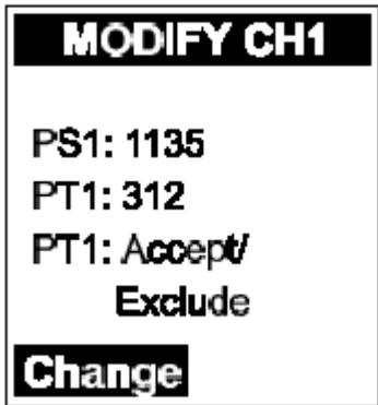
19、利用“**MODIFY CAL**”（更改校准数据信息）菜单输入实验室实际分析结果。按**回车键**直至屏幕上显示**PS 1**值和**PT 1**值，按**左键**使**PT 1**值变亮。与步骤7类似，使用**右键**和**回车键**改变显示结果格式。对所有其余的校准点，都重复该步骤操作。
