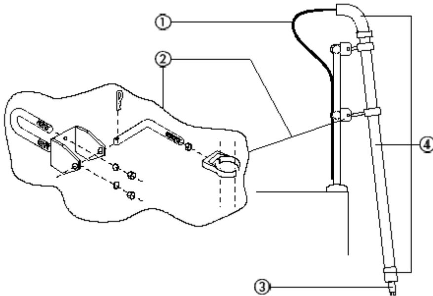
图8 浸没式传感器的安装示意图
