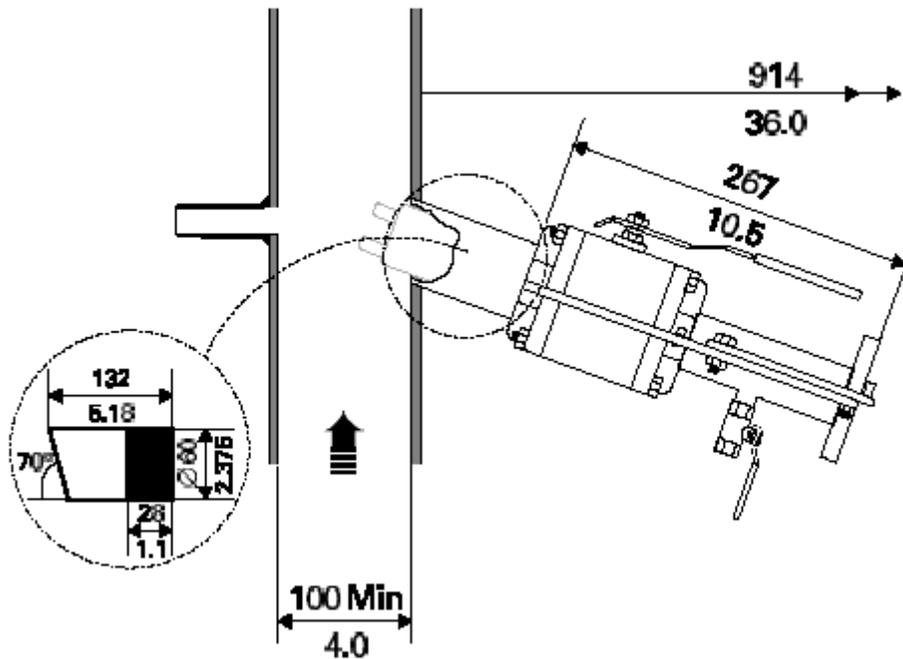
图5 配套球阀装置的柱螺栓安装示意图
