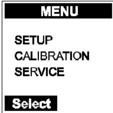
使用**左键**进入“**SETUP**”（设置）菜单；然后继续使用**左键**使光标滚动至“**DISPLAY**”（显示）菜单，并按**回车键**确认。
