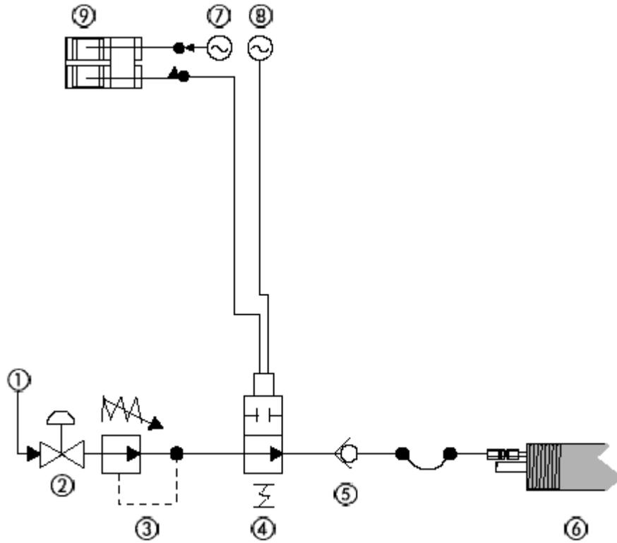
图9 空气清洗装置系统示意图（由用户自行提供）
