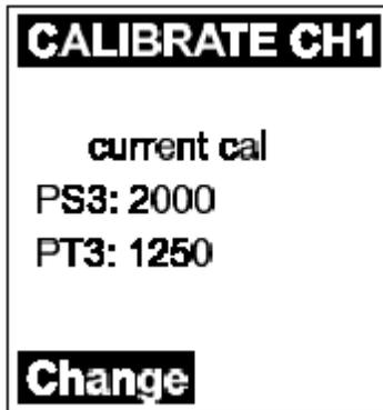
时保留少量样品送实验室分析。对应于校准点的PT序号，将送往实验室的样品编号和贴标签：分别为2、3或者4。
