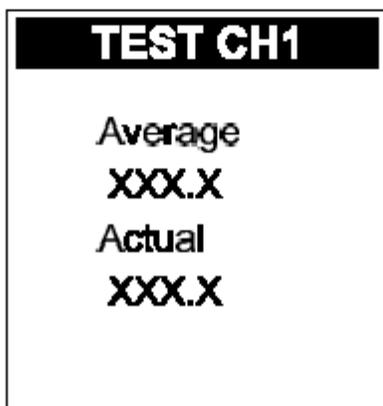
“**TEST**”（测试）：您可以同时观察平均值测量结果和瞬时值测量结果。按**左键**使光标滚动至“**TEST**”（测试）选项，然后按**回车键**确认。完成操作后，按**退出键**返回上一级菜单。
