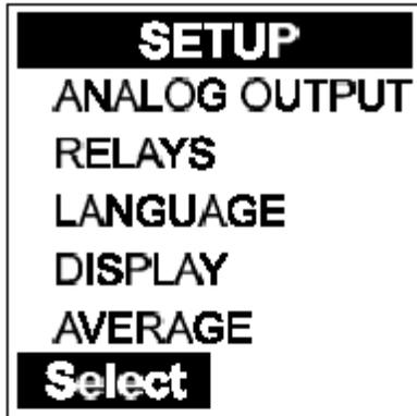
求平均值的目的是为了能获得较平稳的信号，而不至于因为工艺中某些短时间的波动而造成测量数据显示中出现极不稳定的变化。求平均值的过程相当于定义了一个数据波动缓冲器，在测量中按照给定的时间间隔进行给定次数的测量。求平均值的过程同时控制测量结果的显示和电流输出。两个通道的求平均值情况可以有所不同。
