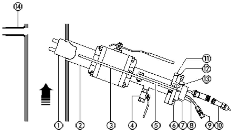
图6 配套球阀装置的安装
