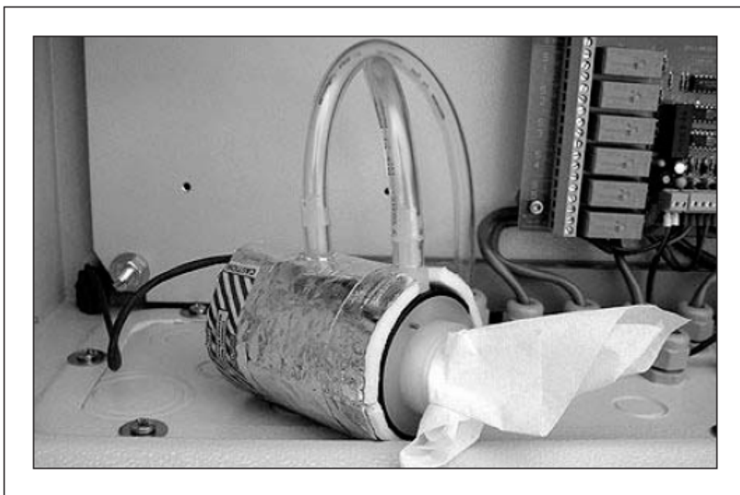
图 7-52 清洗 IR 室组件的内壁
