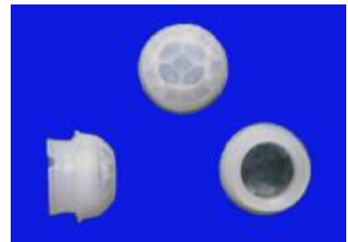
型号: 8120 焦距: 6 角度: 120° 距离: 8m 尺寸: \Phi 12.7 厚度:0.6
