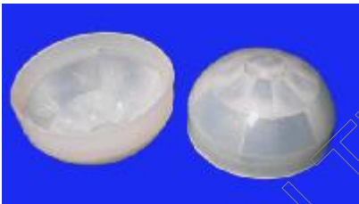
型号: 2814 焦距: 10.5 角度: 140° 距离: 6m 尺寸: \Phi 28 厚度:0.6
