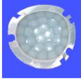
型号: 8603-5(豆粒形透镜) 焦距: 12 角度: 116° 距离: 5m 尺寸: \Phi 39
