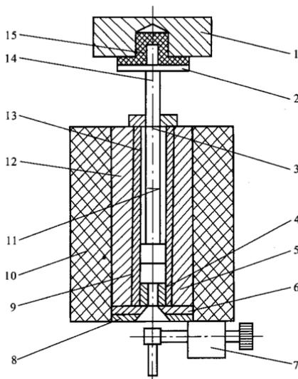
图 1 熔体流动速率仪结构示意图
