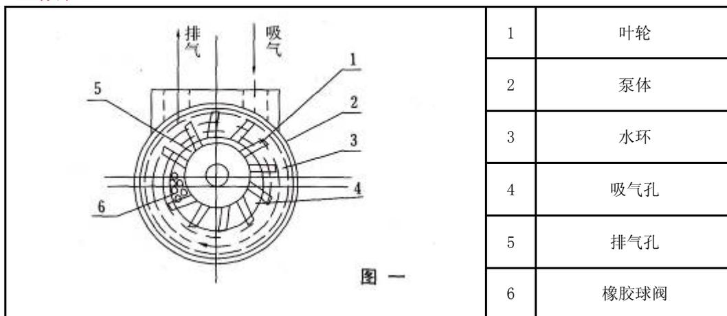
该泵为悬臂式结构，如图~所示、叶轮(1)偏心的装在泵体(2)内，因此当叶轮旋转时，水受离心力的作用，在泵壁上形成“旋转水环(3)，水环上部与轮毂相切，沿箭头方向旋转，在前半转的过程中，水环内表面逐渐与轮毂脱离，因此在叶轮片间形成空间并逐渐扩大，这样就从吸气口吸入气体，在后半转的过程中，水环内表面逐渐与轮毂靠近，叶片间的空间体积逐渐减小，叶片间的气体被压缩而排出。
