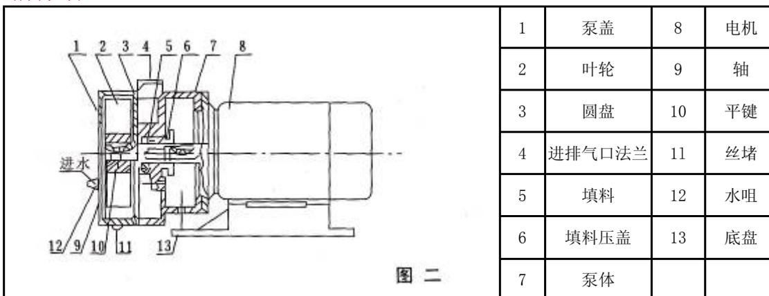
泵的结构如图二所示：主要是由泵盖、叶轮、泵体组成，泵体上部有进排气口法兰，轴偏心装在泵体内，叶轮用平键固定于轴上，叶轮与泵盖及圆盘间的间隙，用泵体和圆盘之间的垫子来调整，此间隙决定气体在泵内由进气口至排气口流动中损失的大小。
