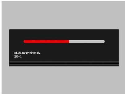
速度估计是一种运动知觉,是指人们对物体运动速度感知的判断能力。它能表征各个人之间心理素质的差异。速度估计检测仪就是这种心理特征检测仪。用于检测人们感知运动物体的速度,并做出准确判断的能力,在心理学研究中有广泛的应用。对机动车驾驶来说,能否正确估计来往车辆、行人移动的速度并及时改变自己的驾驶行为,对保障安全行驶、避免发生事故有重要意义。因此,速度估计检测仪被广泛用来检测驾驶人,是驾驶适性检测系统的重要组成设备。
