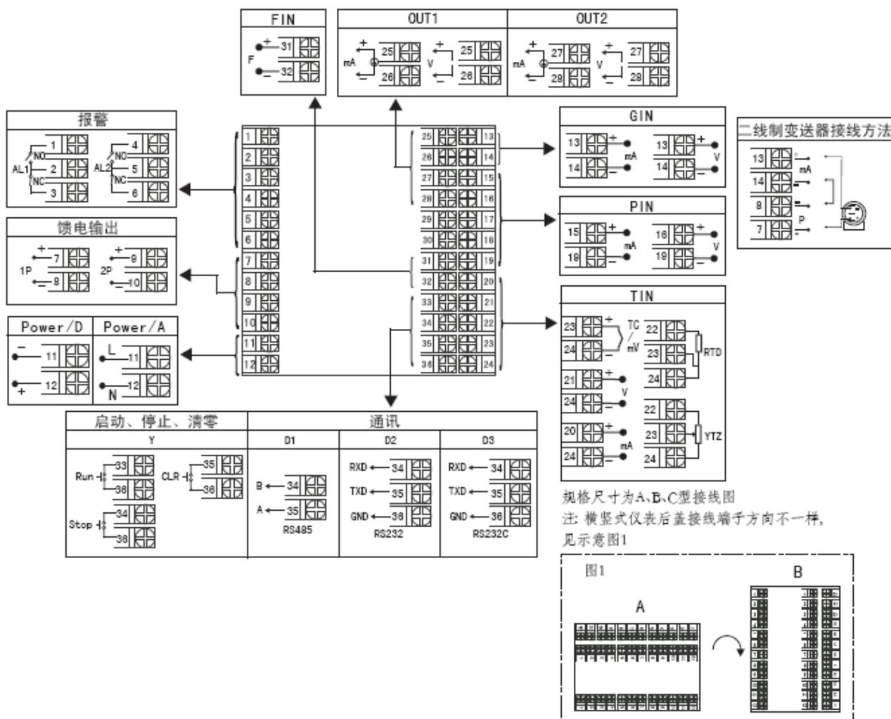
规格尺寸为A、B、C型接线图
