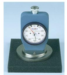
GS-744Gをスポンジシートに置いて、硬さを測定しています。発泡具合の分散性も判定できます。
