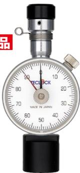
ゴムやエラストマーなどの薄物シートの硬さ測定を行う、簡易硬さ計です。押針の高さは通常のデュロメータの2.5分の1の1mm。シートの硬さの分散性や相対比較に有効です。テクロックのオリジナル規格ですが、得られる値はタイプAデュロメータに近い値になるよう、設計しました。
