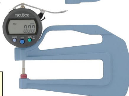
SMD-550J 差し込み深さ120mmのため、 シート状ワークの測定に有効
