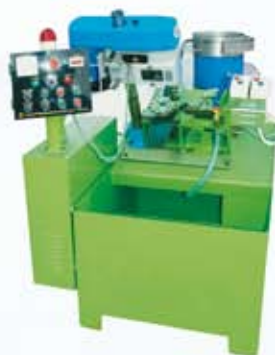
气压式单轴盲孔攻牙机 M3-M32
