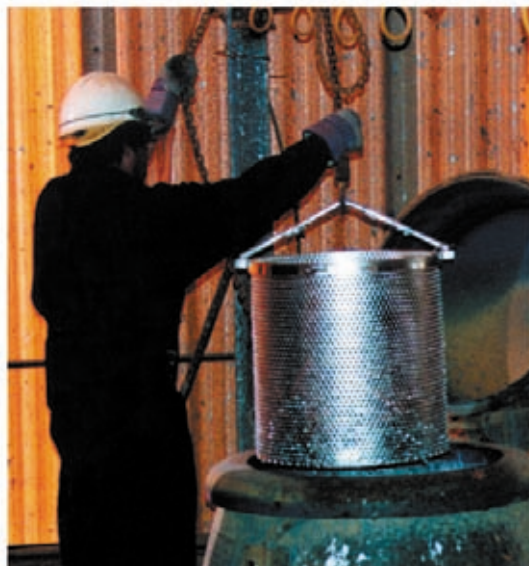
●图1盛有紧固件的篮子刚离开镀锌罐,准备放入离心分离机
