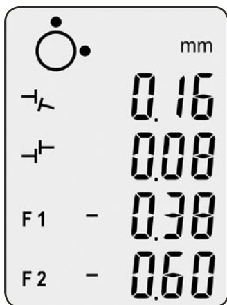
图21. 显示垂直方向上的对中情况
