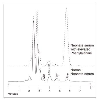
Pickering Laboratories开发了一种采用高效锂离子交换柱的快速PKU-MSUD检测法。此色谱柱广泛地应用于生理液中的氨基酸分析。
