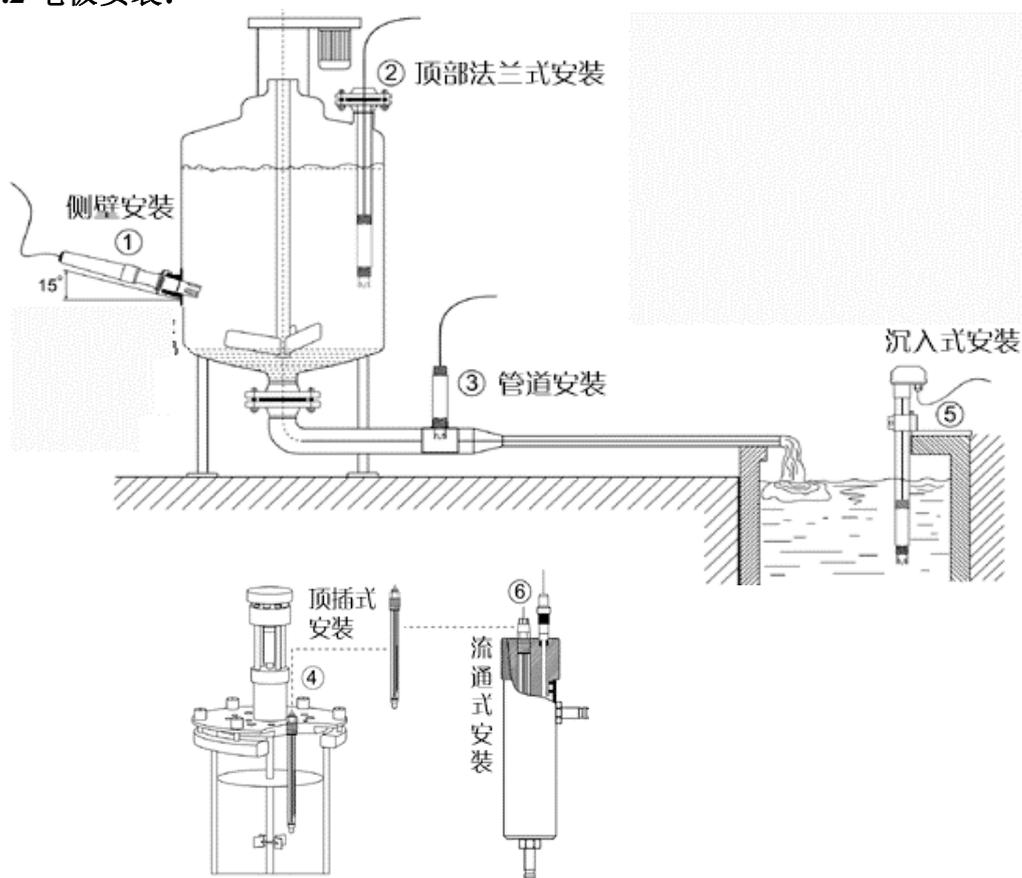
图二 多种安装方式参考图
