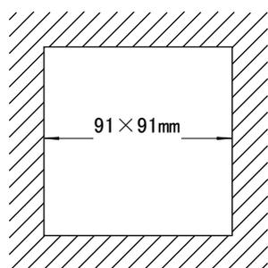
图一 仪表安装开孔尺寸
