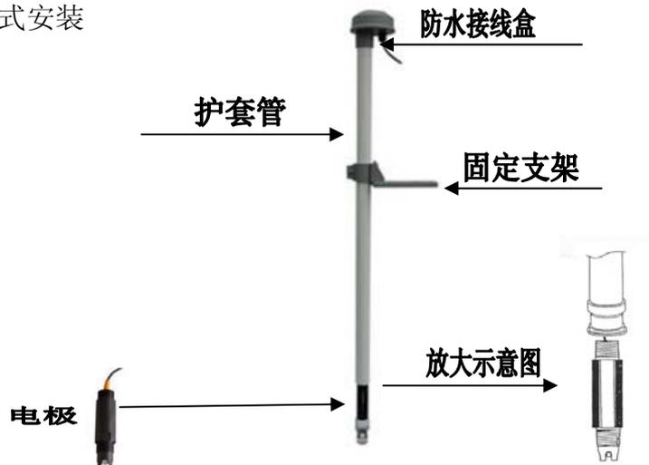
说明：将电缆线从护套管中穿过，电极尾部螺纹与护套管内螺纹连接（使用防水胶布等进行防水处理），如使用两根护套管，两根护套管之间的连接一定要防水，防止水溶液渗透入护套管内腐蚀电缆线，将护套管固定在固定支架上，护套管顶部用黑色防水橡胶帽盖住防止雨水从顶部进入护套管内。
