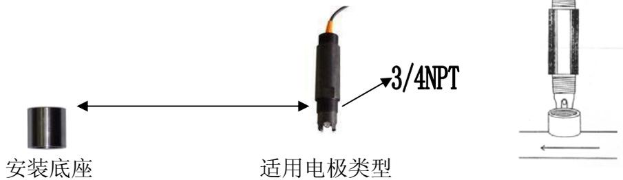
④、顶插式安装：直接将电极插入小型反应釜
