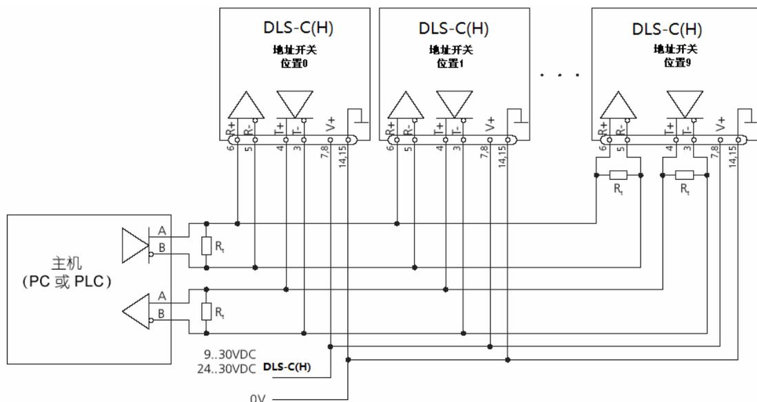
图5 用 RS422 连接多台设备
