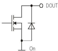
DLS-C(H)有两个数字输出口用于电平监视（DO1 和 DO2），一个数字输出口用于发送出错信号（DO E）。这些输出都是开路输出。如图 7 所示。它们都可抬高到 200mA。最大开启电压为 30V。在 ON 的状态下，FET 晶体管导通。
