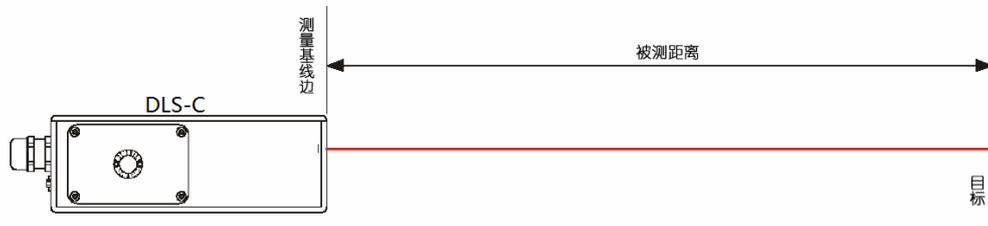
DLS-C(H)是一种功能强大的测距设备，它可被集成用于各种工业用途。通过一束激光反射，使得精确、无接触式长距离测距成为可能。
