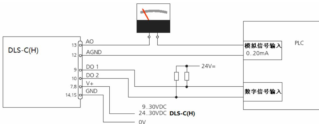
图6 将仪器与 PLC 相连接
