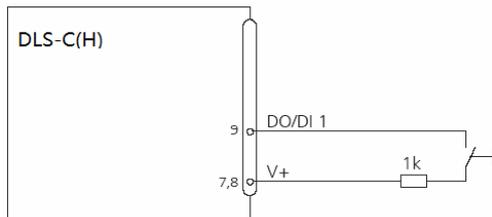
以下命令用于配置数字输出端 DO1。这个端口也可用于数字输入。出于安全角度考虑，请串联一个电阻来保护连接端口。
