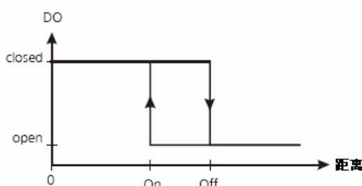
如果测量的距离逐渐减小，当距离低于 ON 电平，数字输出开启（开路输出关闭）
