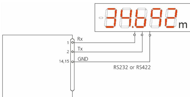
如果显示模式可用，DLS-C(H)将距离数据转化为外接显示器可读取的 ASCII 字符串通过串口传输外接显示器。当完成测量后，DLS-C(H) 通过串口自动输出这种格式的字符串。测量结果就可以在没有其他控制器的情况下，显示在外接显示屏上。关于这种模式的详细说明，请联系您的 DIMETIX 中国或供应商。
