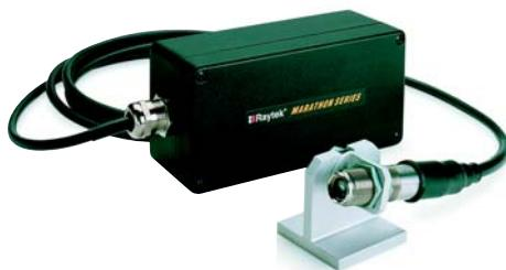
FR1系列探头使用光纤技术可克服测量过程中的各种极端环境条件。将探测器和信号处理电子部分远距离地放置在一模铸保护套中，光纤探头和电缆可安装在强电磁场中的地方，环温可达200°C。
