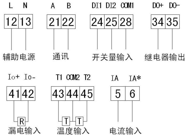
注：电流互感器红色线接 6 号端子，黄色线接 5 号端子。
