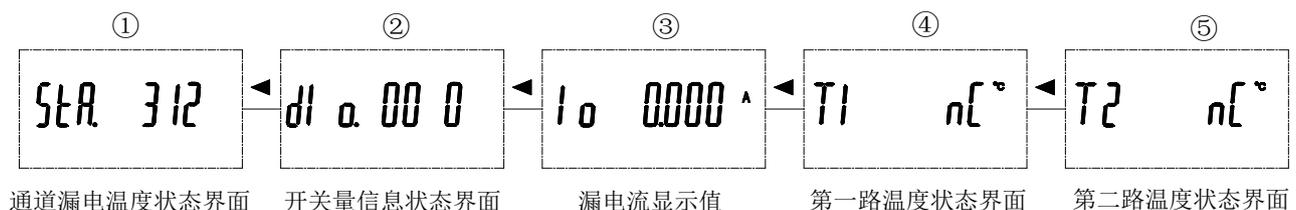
通道漏电温度状态界面 开关量信息状态界面 漏电流显示值 第一路温度状态界面 第二路温度状态界面
