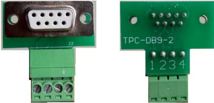
转接头的 3 为 B，4 为 A，COM1 端子为下行端口，连接 AMC16 模块；COM2 端子为上行端口（同样 3 为 B，4 为 A），用于将屏内数据转发到动环监控系统。
