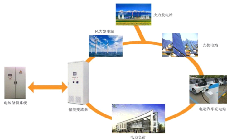
图 1 风光储充微电网典型结构
