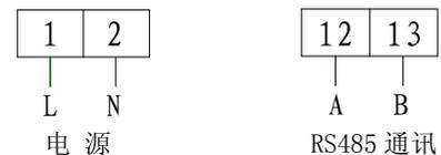
注：当辅助电源为 DC48V 时，“1”接电源“-”端，“2”接电源“+”端。
