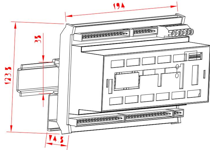
图3 ARTU-T 导轨式 35mm 安装图
