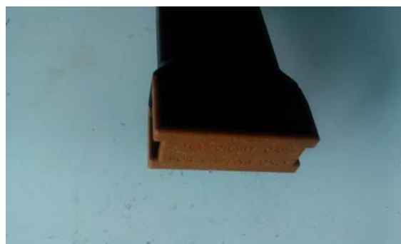
图 3-4 交流接线头盖上保护盖
