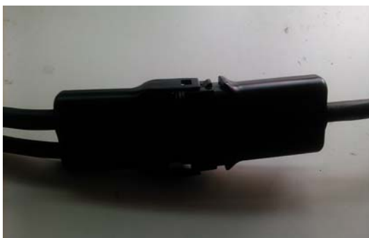
图 3-3 交流接线头连接
