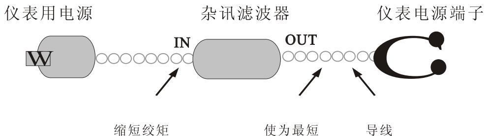
(3) 配线请使用符合电气用品管理法的电线(仪表接地使用导线公称截面积压1.25~2.0mm<sup>2</sup>左右的线材, 请以最短距离接地)。
