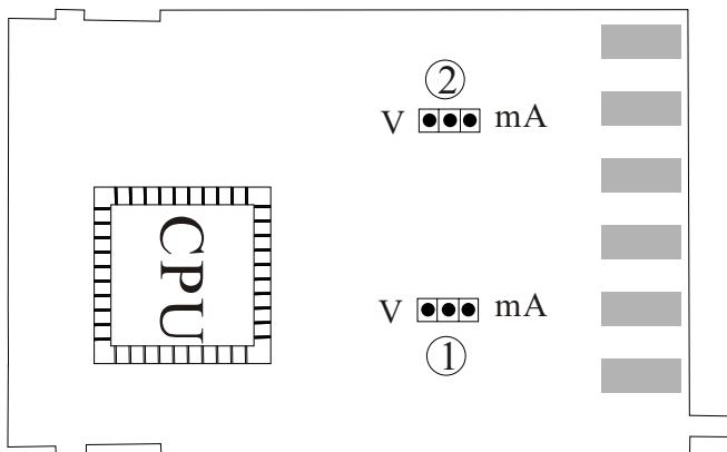
D935、D435、D735系列仪表主板示意图中①可切换PV1输入信号,②可切换PV2输入信号。当短路环插到mA端时输入信号为mA,当插到V端时输入信号为V信号。仪表出厂为mA信号,如果不是V信号输入时请不要切换或拔掉短路环,否则仪表不能正常测量显示。
