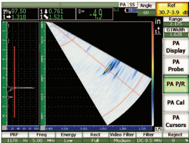
AWS焊缝评级 - 图中为60度聚焦法则的AWS “D” 值焊缝评级。
