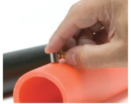
使用接触式探头，可以利用超声技术对各种直径的塑料或金属管材、管道进行操作简便的测量。小直径的管材、管道可能会要求使用水浸式测量方法。
