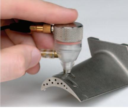
35型仪器利用延迟线式探头或水浸式探头，可对涡轮叶片的凸面和凹面进行精确的厚度测量。
