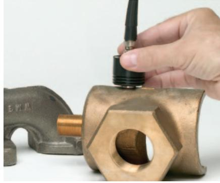
35HP测厚仪可以测量汽缸内腔和许多其它金属铸件以及具有声速衰减性的材料。
