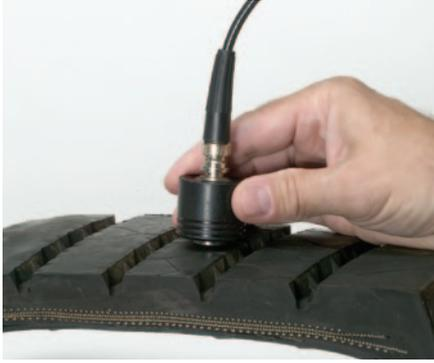
测量橡胶传送带或轮胎中钢帘线的深度。
