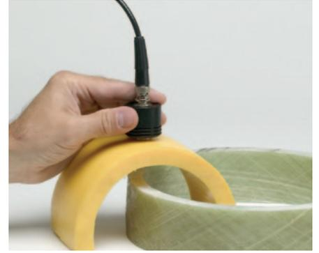
35HP测厚仪是测量玻璃纤维或复合材料工件的理想工具，其测量的对象包括对厚度控制有严格要求的航空航天器部件、船体及储罐。
