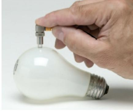
在这种基本应用中不可使用测微计。然而，可以使用35型仪器，利用M208探头，在不损坏玻璃的情况下，进行校准精度达0.001毫米（0.0001英寸）的厚度测量。
