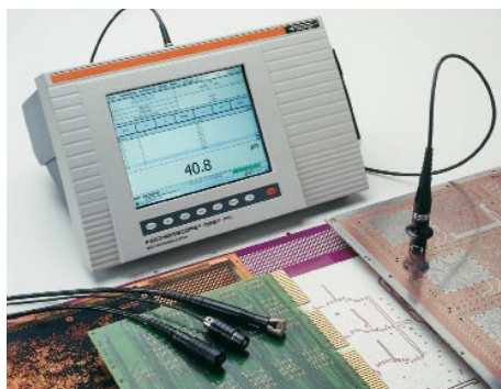
FISCHERSCOPE® MMS® PC 是一款多功能的测试仪器，可集成磁感应、电涡流和beta射线等方法测量涂镀层厚度和材料测试
