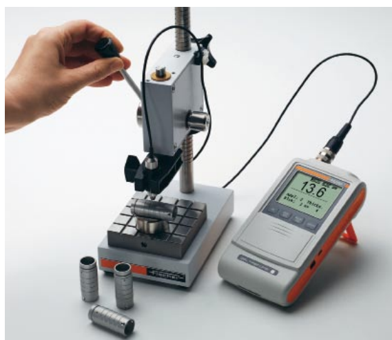
DUALSCOPE® FMP40 - 使用测量台固定圆柱形工件，测量很准确。
