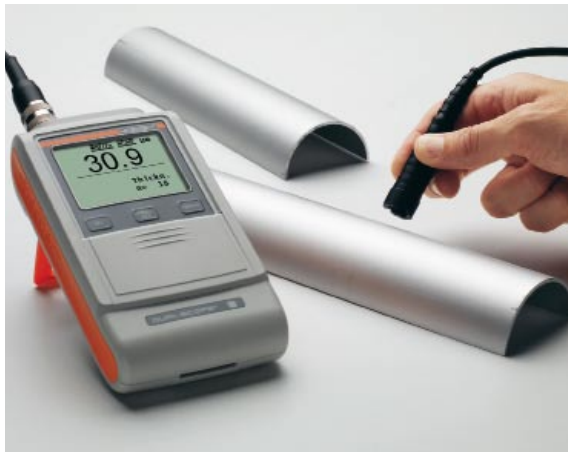
DUALSCOPE® FMP20 和氧化工件，使用带曲率补偿功能的探头 (Fischer专利)。
