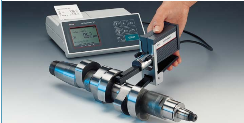
PFM 2 夹轴 可测量直径 5 mm 至 80 mm (100 mm) (.197 in 至 3.15 in/3.94 in) 订货号 6850738
