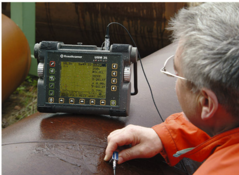
对焊缝进行检测
