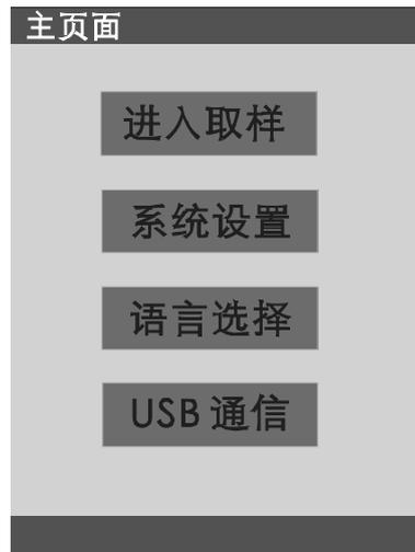
您可以用“上翻 (up)、下翻(down)”按钮选择。我们先选择“进入取样”，按“确定”进行“样品测试”。在没对系统进行设置的情况下，您所测得的数据默认为 D65 光源条件下的测量数据。您也可以进入“系统设置”，设置修改成其它光源。另外还有两个备选光源 D50、F11 光源。
