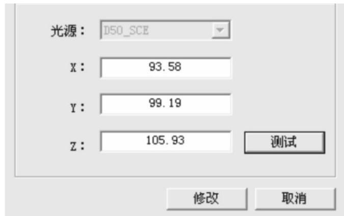
如果你要修改上图中的 XYZ 的值，就在 XYZ 对话框中输入您要修改的值。如下图，本例是将白板值修改成 X=94.00 Y=99.00 Z=106.00。将 XYZ 的值分别填入框中，点“修改”，修改后的 XYZ 值，就是当前对话框中的值。X=94.00 Y=99.00 Z=106.00，该值将代入下一步运算。
