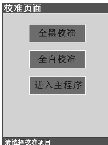
按以下步骤，完成“全黑校准”、“全白校准”、之后，请您使用仪器的上下翻页键，选择“进入主程序”，再按“确定”键，进入下一个页面“进入取样”页面。
