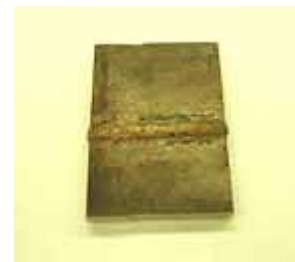
图 5. 焊缝部件照片
