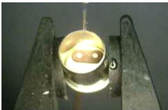
图 3 裸露桥线电阻丝的 EED
