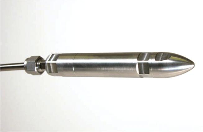
OPP-W是一个光纤压力和温度传感器，基于法布里-比罗特干涉仪。高持久性蓝宝石核心和坚固的镍铬铁合金718封装相结合，使得此传感器为极端石油&天然气井下环境提供选择，比如蒸汽辅助重力分离（SAGD），蒸汽循环激励生产法（CSS）和HT井。
