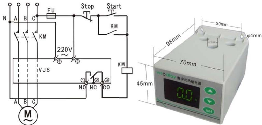
NO 为内部继电器常开点，NC 为常闭点，CO 为公共点。保护器在断电状态下，内部继电器是在释放状态，1、3 断，2、3 通。通电后，继电器立即吸合（如果启用了时间继电器功能，则延时吸合，见参数 F61），1、3 通，2、3 断，控制接通电动机电源。当检测到电动机出现故障时，继电器释放，断开电动机电源。
