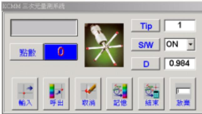
顯示目前執行之量測動作，並提供選項以終止、取消、或呼出量測
