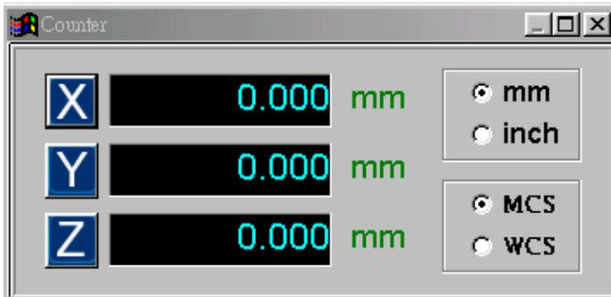
顯示X、Y、Z座標值，公/英制，機械/工件座標。
